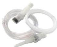
TOUS les DLX sont fournis avec un kit d'installation PVDF-FPM standard, composé d'un tube de refoulement en PE de 2 m (4x6 mm), d'une aspiration en PVC cristal de 2 m (4x6 mm), d'un filtre à pied en PVDF, d'une valve d'injection en PVDF. D'autres configurations sont disponibles sur demande.
